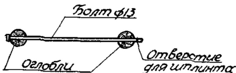
Черт. 6 Установочный болт для наклона коробки.
